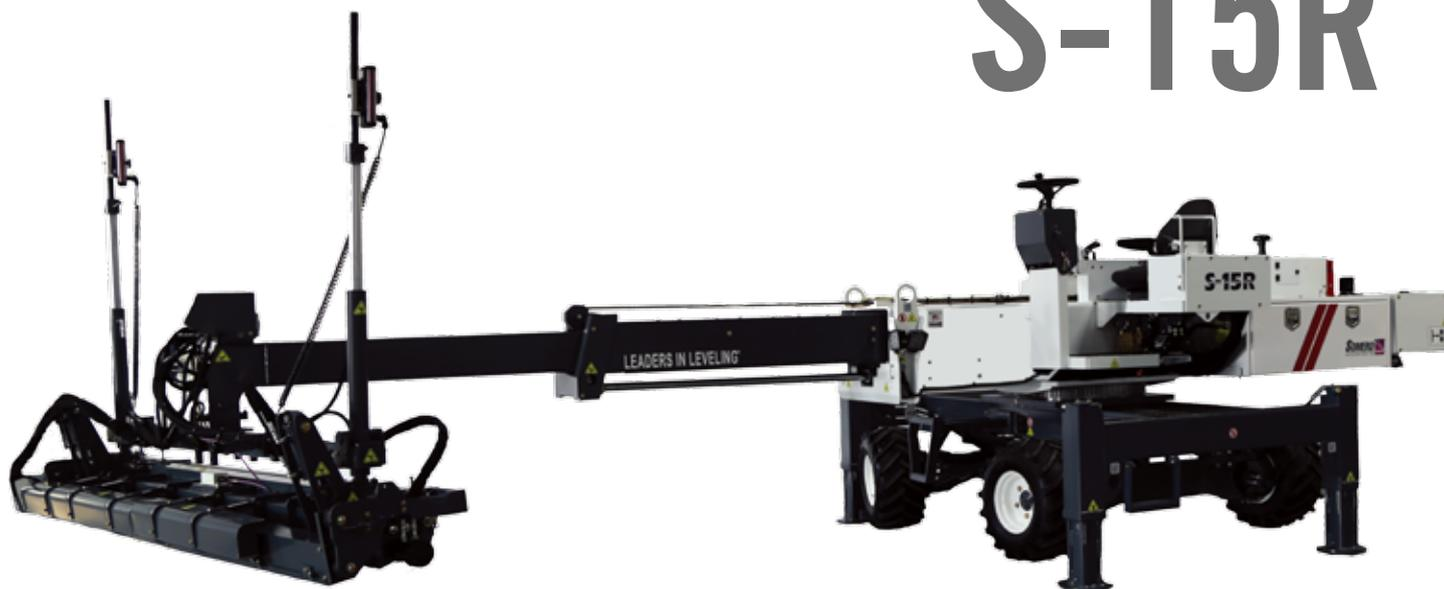
**S-15R** 型激光整平机是一台具有极高价值的高性能精密机器，具有一道摊铺即可完成刮平、整平和振捣压实工作的集成式整平机头。刮板将高处的混凝土刮至低处，而朔马珞机器的“Quick Pass”功能将卸料时堆积过高的混凝土摊铺开，而不用人工介入。液压驱动的螺旋将混凝土切到基准面，并将多余的混凝土通过双螺旋和偏置刮板输送至右侧。同时，延伸出的弯折挡板将右侧积高的混凝土进一步摊平并推送至螺旋布料区，使搭接宽度达到最小。
