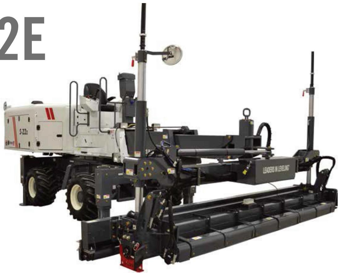
朔马珞公司的 **S-22E** 型激光整平机是当前世界最先进的激光整平机。它能够为您提供多种选择，让您根据自身需求合理配置您的机器。该型号机器能够进行  $360^{\circ}$  旋转，配置了  $20'$  /  $6m$  的伸缩臂和单独触摸式支腿控制器。可选配的滚筒式刮板置于刮板底部，在起到提浆作用的同时，可将大骨料及钢纤维压下去。便于操作人员在一道摊铺中就能够完成混凝土封面。特别适用于坍落度很低的混凝土，或者含有大骨料与钢纤维的混凝土。
