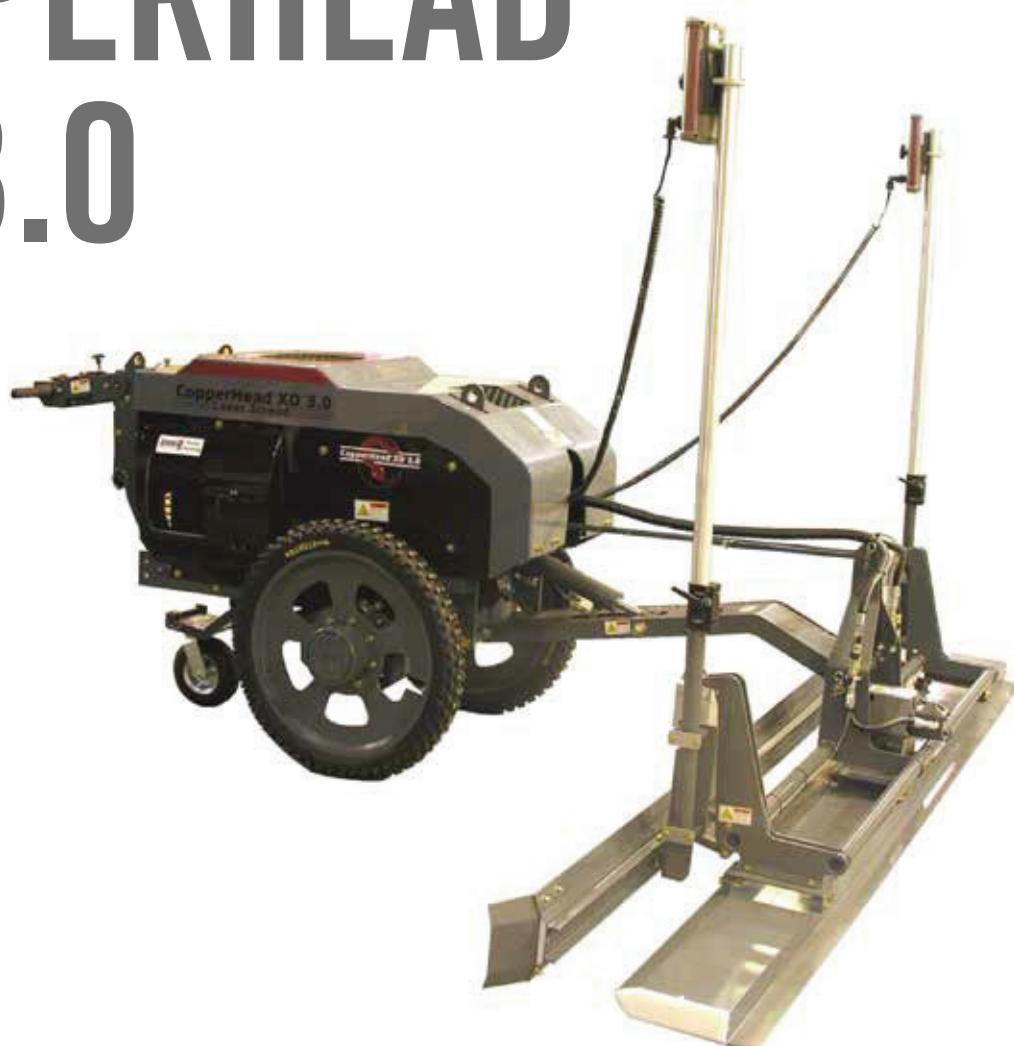
将您的混凝土刮到设定标高，整平并振动密实，所有步骤一次完成。这种自驱式的CopperHead® XD™ 3.0激光整平机，可以为您带来卓越的生产率和平整度，且具有世界第一款手扶式激光整平机的所有益处。像朔马珞所有机型一样，CopperHead® 激光整平机能够自动设定标高，使操作人员能够快速高效地施工。用于地面或楼面的平面浇筑时，这款机器是小型商业项目、楼面或住宅项目的理想选择。
