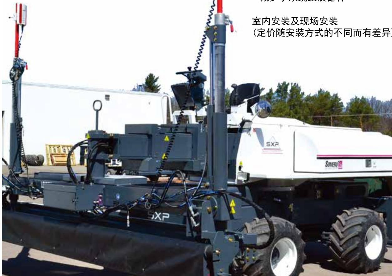
机器部件包括：控制器、操作显示屏、激光接收器、双轴角度传感器、液压控制阀及遥控器开关盒(SXP系列除外)
