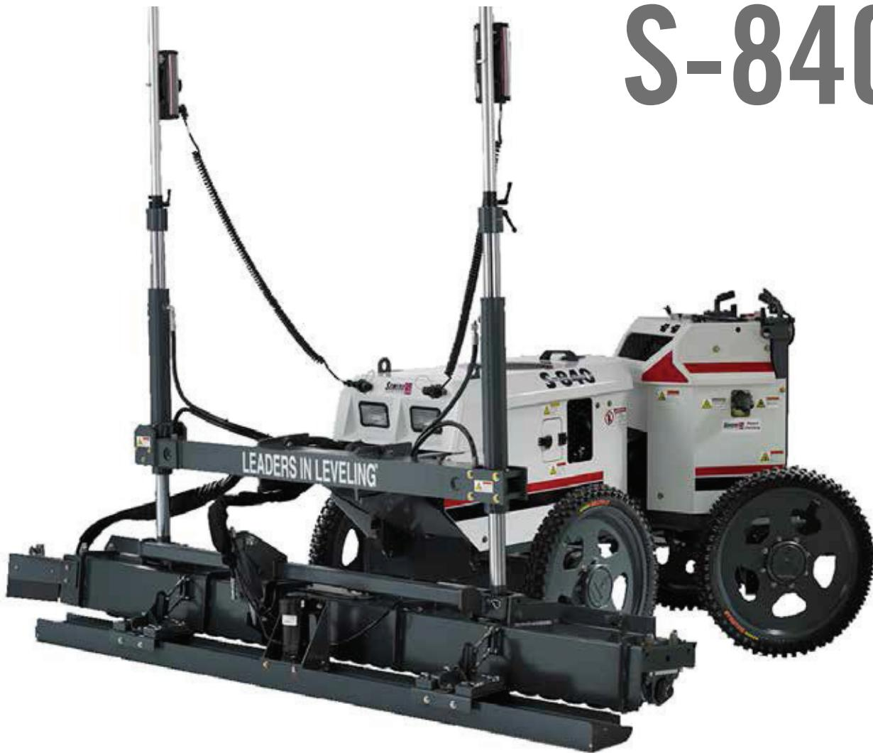
如果您想获得更高的地坪水平度，**S-840** 型激光整平机能为您提供比任何其它机械方法都要好的性能，而且是现有的通用性最高的混凝土机械。S-840型激光整平机有三种选配形式便于您挑选：全自动自平衡整平机头、混凝土初平机头、垫层整平机头。使用S-840设备施工，由于您在每个项目中使用的人工更少，自动整平过程也就提高了利润率，而且，可以自定义的控制系统能够进行更快的抬升操作和SLS响应。S-840型激光整平机平均每小时能够整平5000平方英尺的地坪。
