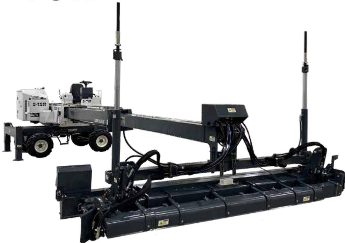
**S-15R** 型激光整平机是一台具有超高价值的高性能精密设备，具有一道摊铺即可完成刮平、整平和振捣压实工作的集成式整平机头。刮板将高处的混凝土刮至低处，而朔马珞机器的快速刮平功能将卸料时堆积过高的混凝土摊铺开，而不用人工介入。液压驱动的螺旋将混凝土切到基准面，并将多余的混凝土通过双螺旋和偏置刮板输送至右侧。同时，延伸出的折叠挡板将右侧积高的混凝土进一步摊平并推送至螺旋布料区，使搭接宽度达到最小。
